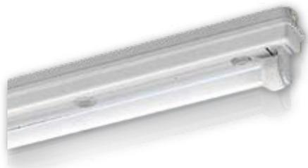
Feuchtraumleuchte aus hellgrauem glasfaserverstärktem Polyester. Das zweiteilige Gehäuse ist schwer entflammbar und verfügt über unverlierbare Drehverschlüsse. Mit vielfältigen Möglichkeiten zur Kabeleinführung. Mit 25 V LED Converter. Verdrahtung anschlussfertig mit wärmebeständigen Leitungen und Anschlussklemme.
