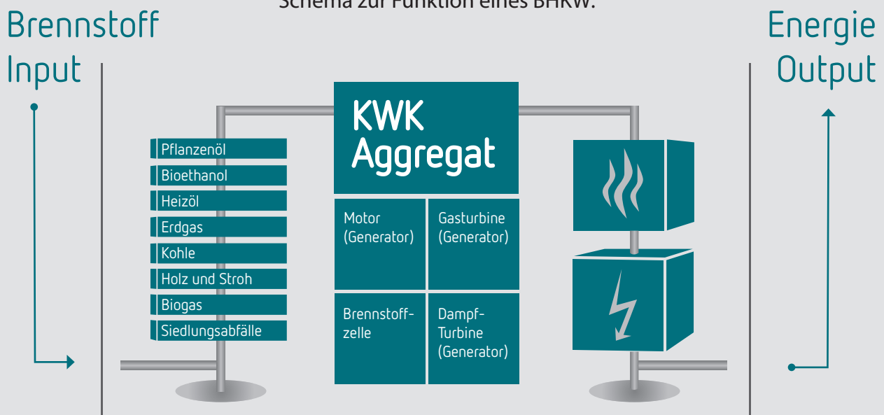
Schema zur Funktion eines BHKW:
